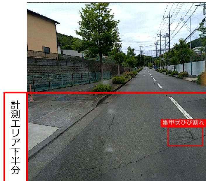
計測エリアの全体で路面部分をとらえ、下半分側に路面がしっかり写っている。
