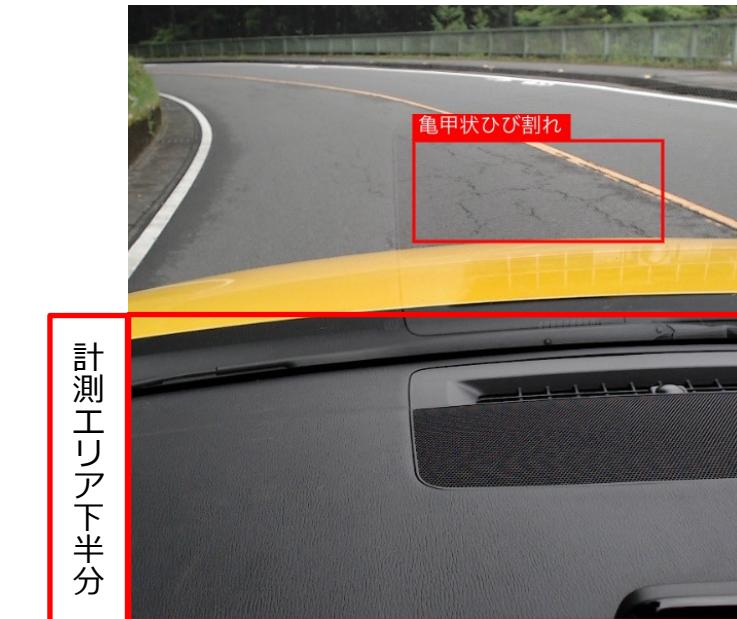
計測エリア下部にダッシュボードが大きく写てしまい、誤検知や検知漏れ発生の可能性が高くなる。
