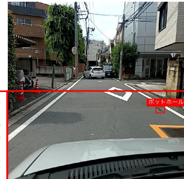
ボンネットが前方に長いため、計測エリアに写ってしまっている。しかし、路面もしっかり写っているため、検知可能である。
